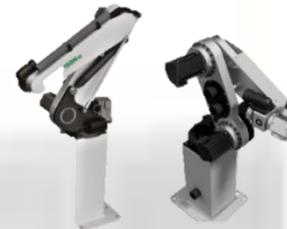
Dall'anima più tecnologica del Gruppo nascono **robot cartesiani** e **robot antropomorfi** di alta precisione, che trovano applicazione in processi come dispensazione, avvitatura, manipolazione, fresatura e saldatura, consentendo di incrementare le prestazioni e l'affidabilità delle macchine.
